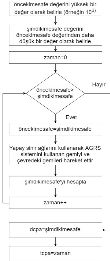
Şekil 5. TCPA ve DCPA değerlerinin hesaplanması (Calculation of TCPA and DCPA)
