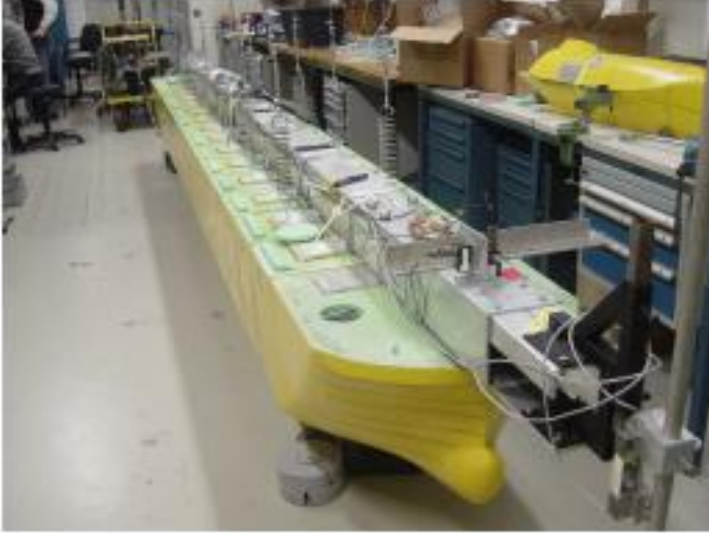
Şekil 5. Hidroelastik olarak ölçeklendirilmiş modelin fotoğrafı (Iijima ve Ark., 2009).
