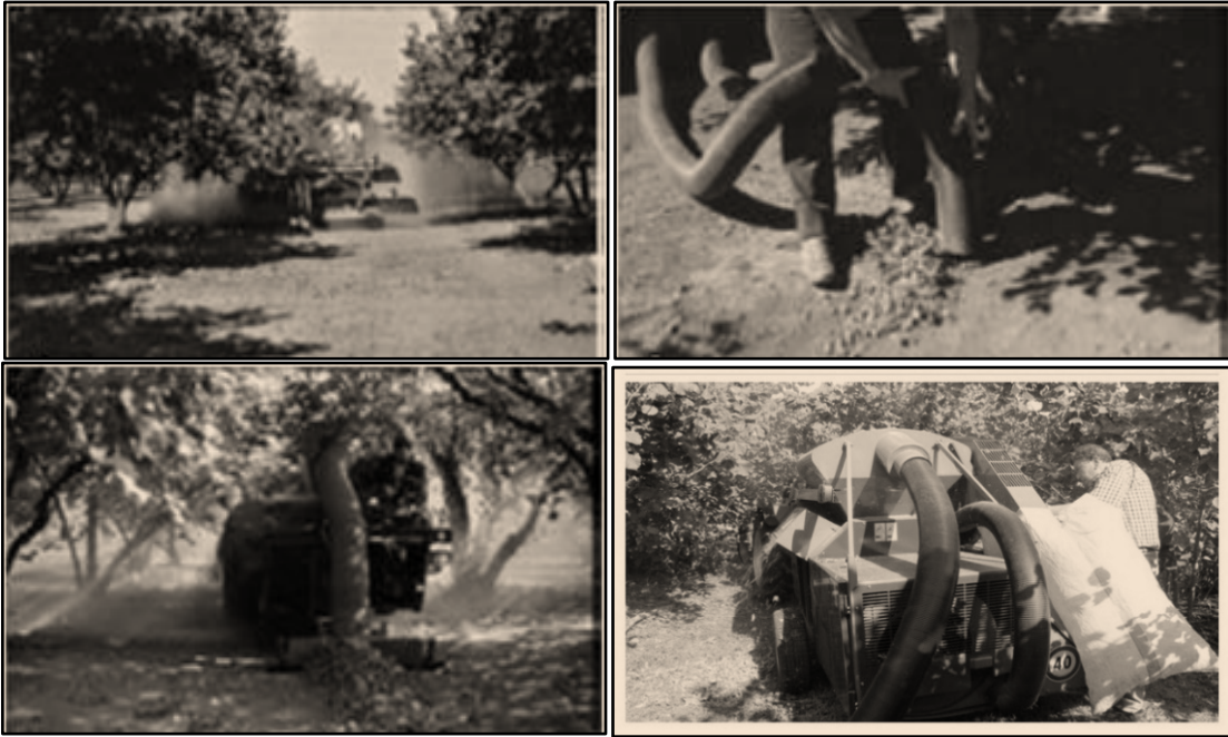
Şekil 5. İtalya'da, süpürücülerle namlu yapılan fındığın el ile yönetilen ve kendiyürür aspirasyonlu makinalarla toplanması (Tombesi, 2005).
