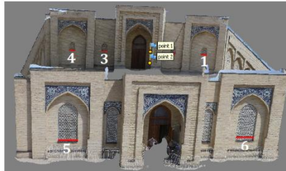
Şekil 9. 3B modeli ölçeklendirmek için kullanılan hatlar
