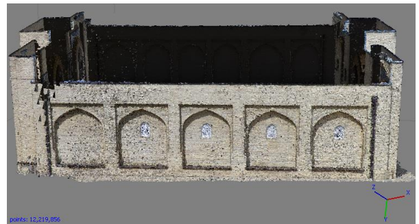
Şekil 6. Yoğun nokta bulutu (Dense Point Cloud/~12milyon)
