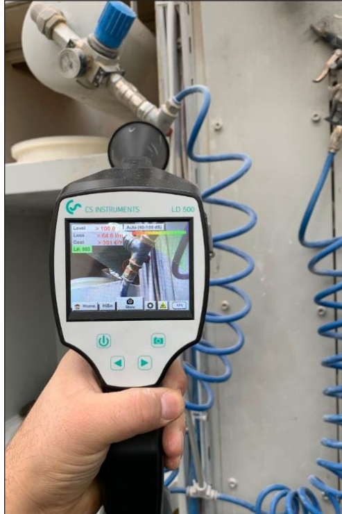
Şekil 10. Ultrasonik Dedektörle Kaçak Tespiti
