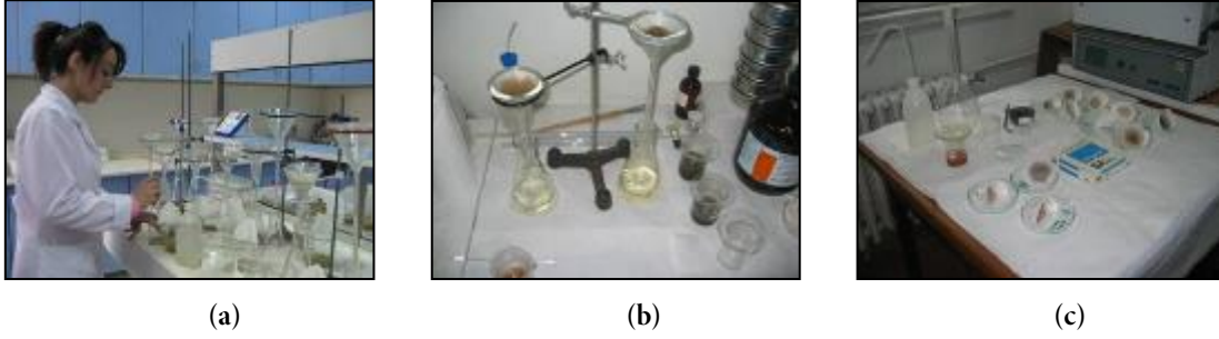
Fig. 6. Asidik agrega & bağlayıcı analizi; (a) Asidik işlem (%5 HCl), (b) Süzme / yıkama ve (c) Kurutma işlemleri (MAKLAB Fotoğraf Arşivi)
