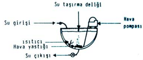
Şekil 1. Tohum çimlendirme cihazının şematik gösterimi (ÖNAL, 1995)
