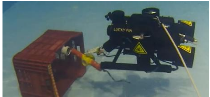
Şekil Ek 2. Kocaeli Üniversitesi Lucky Fin Sualtı Aracı + Manipülatör sisteminin sualtı testleri
