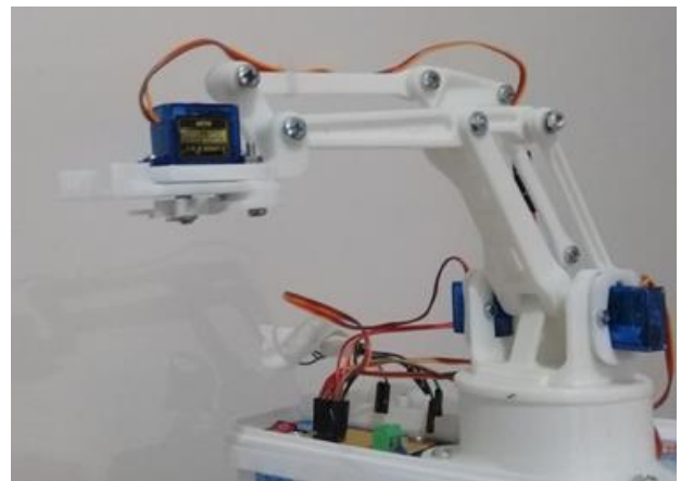
Şekil 4. İki eksenli manipülâtör (Çalışmada 3. eksen kontrol edilmemiştir)
