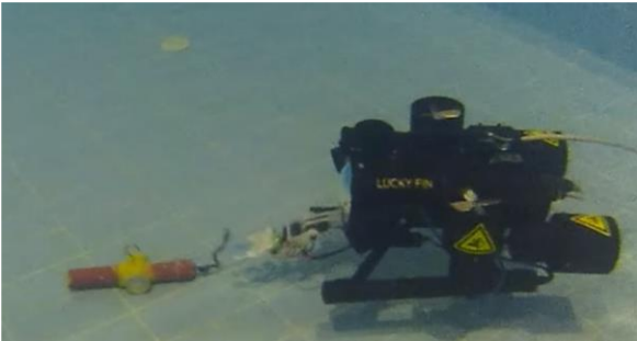
Şekil Ek 2. Kocaeli Üniversitesi Lucky Fin Sualtı Aracı + Manipülatör sisteminin sualtı testleri
