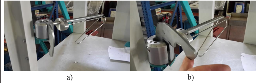
Şekil 1. Hali Hazırda Kullanılan Bobin Tutucu Sitemi. a) Çalışma Pozisyonu, b) Kilitinin Açılması ve Bobin Yükleme İçin Döndürülmesi.
