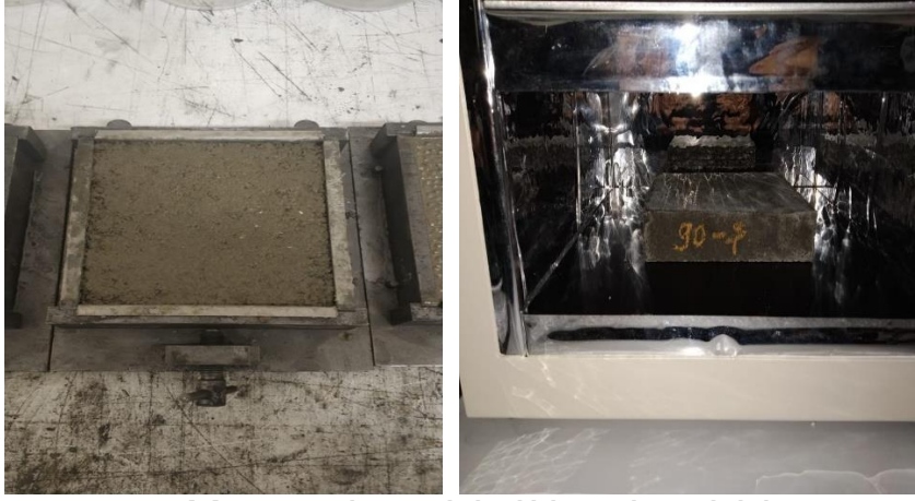
Şekil 3. Numunelerin ısı iletkenlik katsayılarının belirlenmesi
