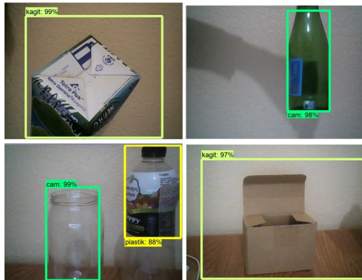
Şekil 8. Eğitim sonunda elde edilen modelin bazı resimler için verdiği sonuç olasılık değerleri
