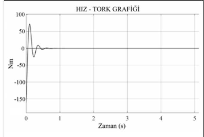
Şekil 13. MPC denetimli yalpanın uç işlevcisinin hıza göre tork-zaman değişimi.
