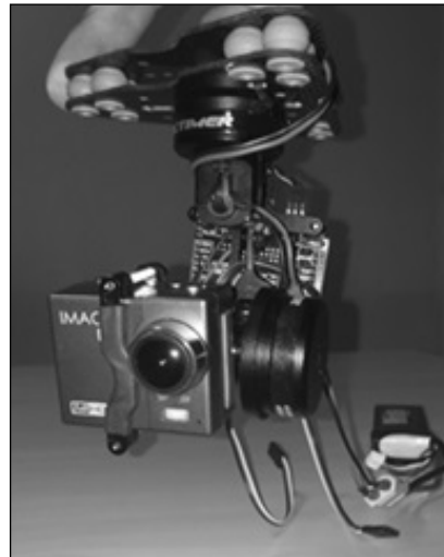
Şekil 12. Dört pervaneli İHA üzerinde bulunan RRR eklem yapısına sahip yalpa.
