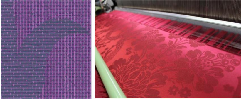
Fotoğraf 1.Çözgü ve atkı yüzü saten simülasyonu (Başaran 2019), damask dokuma aşaması (URL 2)
