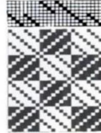
Şekil 6. Blok damask 3/1 ve 1/3 diyagonal dimi S/Z (Cizsuk, 2004: 109).
