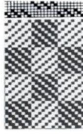
Şekil 5. Blok damask 2/1 ve 1/2 diyagonal dimi Z/S (Cizsuk, 2004: 109)
