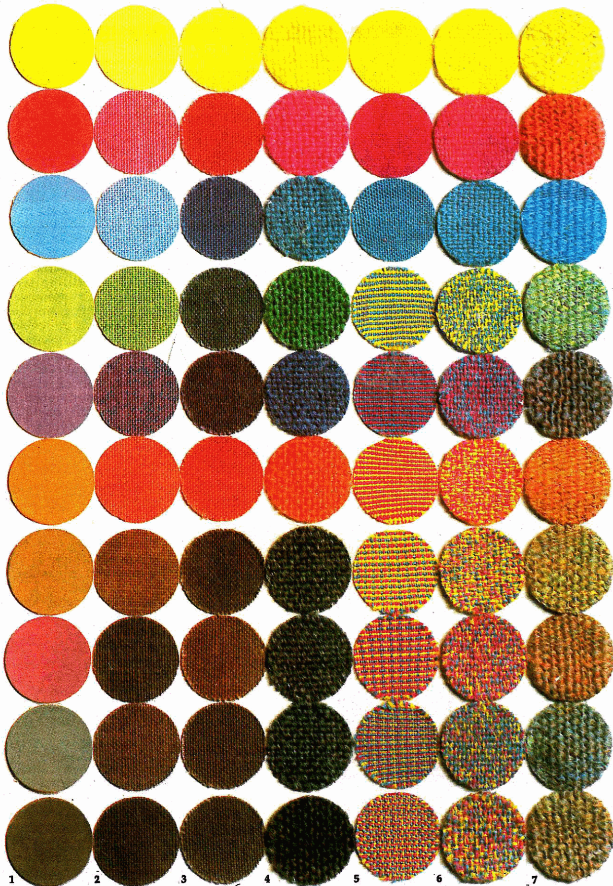
Şekil 8. Tekstil Kapsamında Uygulanan Farklı Renklendirme Yöntemleri 1-Tasarım, 2-baskı, 3-Boyama, 4-Elyaf Renklendirme, 5-Renkli İpliklerle Dokuma, 6-Muline İplikle Dokuma, 7-Melange İplikle Dokuma
