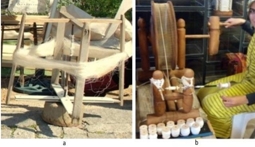
Şekil 3a:İpliğın Elemeye Takılması, b. Çark ileİpliği Çağlık MakaralarınaSarma (Azime Güven Arşivi, Alanya 2019)
