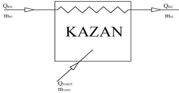
Şekil 2. Kazan tesisatına ait değişkenler.
