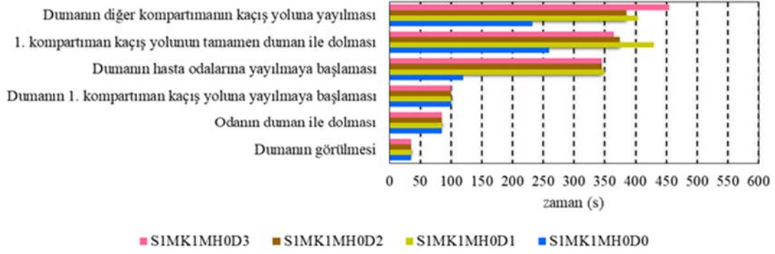
Şekil 12. II. Grup senaryolar için dumanın görülmesiyle başlayan duman yayılımı zaman ilişkisi (Smoke propagation- time relationship starting with the appearance of smoke for group II scenarios)
