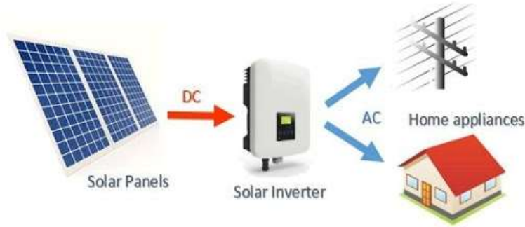
Şekil 15. Solar İnverter Dc-Ac Dönüşümü
