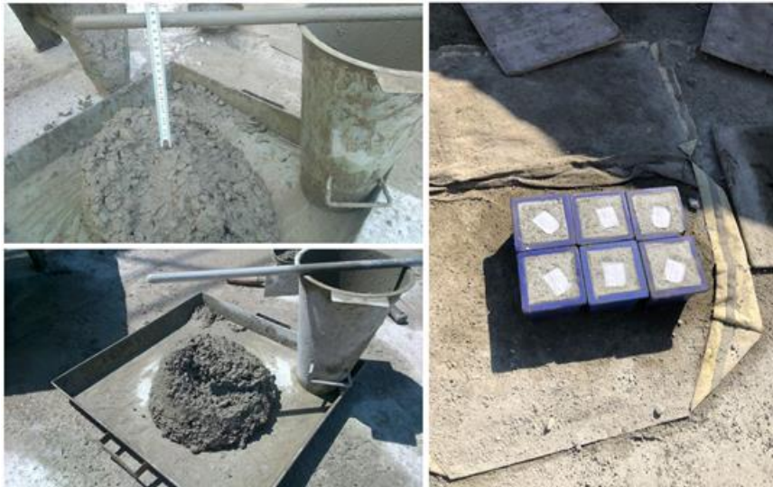
Şekil 4. Çökme Deneyi ve Taze Betonun Kalıplara Yerleştirilmesi (Slump Test and Placing Fresh Concrete Into Molds)
