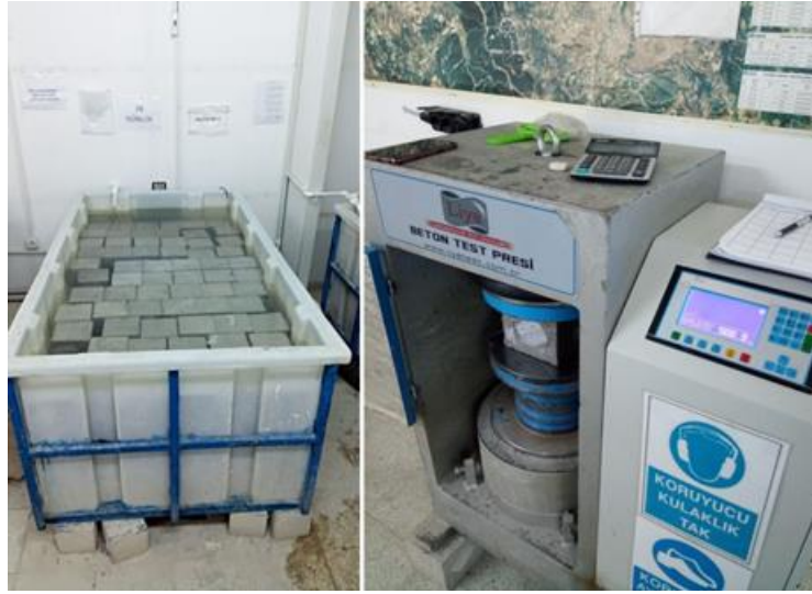
Şekil 5. Kür Havuzu ve Beton Basınç Dayanımı Testi (Curing Pool and Concrete Compressive Strength Test)
