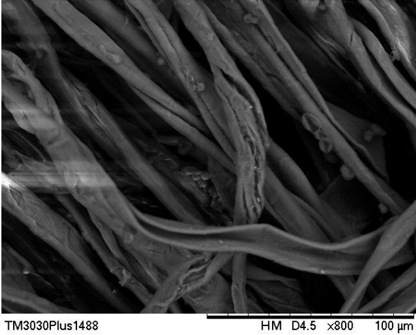
Şekil 7. Bal ve Propolis içeren mikrokapsül SEM görüntüsü
