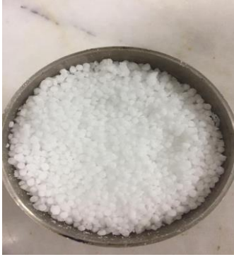
Şekil 1. Stiren-butadien-stiren (SBS) katkısı
