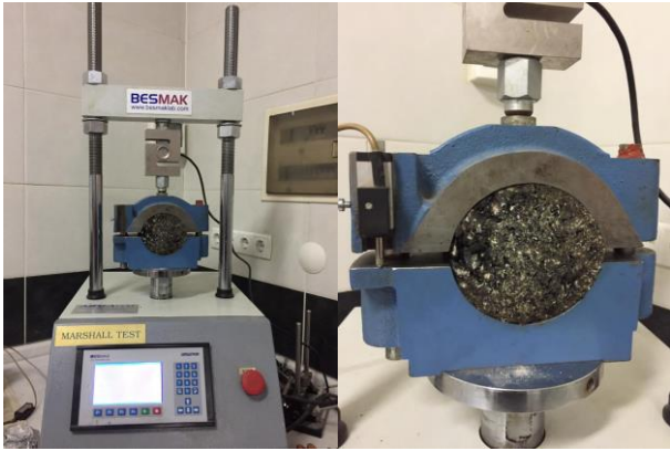
Şekil 4. Marshall stabilite aleti
