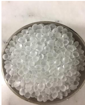
Şekil 2. Etilen vinil asetat (EVA) katkısı
