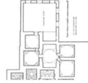
Çizim 36: Tek bir mekân etrafında şekillenen halvet hücreli mekân düzenine bir örnek Mudurnu Yıldırım Hamamı Kadınlar Bölümü (Erat, 1997, c. 45)
