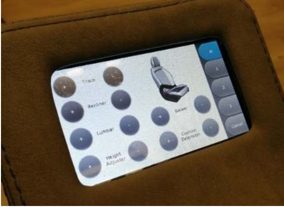
Şekil 11. Dokunmatik ekran kullanıcı ara yüz tasarımı (Design of touch screen user interface)
