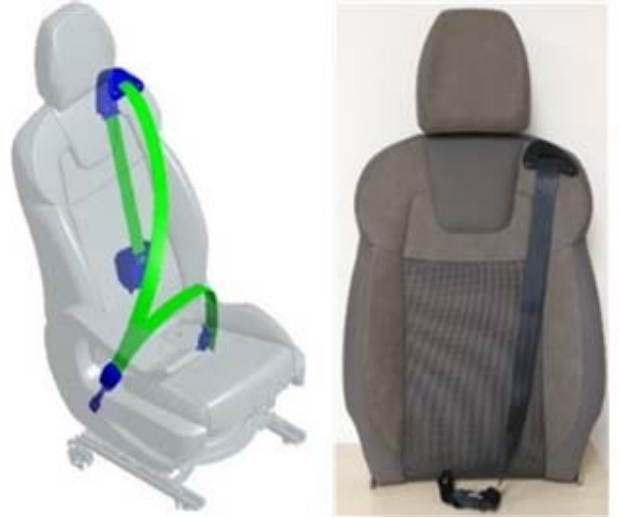
Şekil 12. Üç nokta emniyet kemerli koltuk tasarımı (Seat design with the three-point seat belt)
