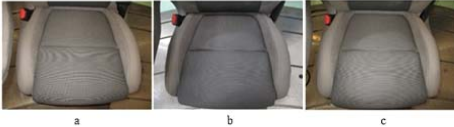
Şekil 15. FIAT 7.N5320 giriş-çıkış testi öncesi (a), sırası (b: 10800 tur) ve sonrası (c: 18000 tur) görüntüleri (Views from the FIAT 7.N5320 entry-exit tests; (a: before tests), during (b: 10800-cycle), and after (c: 18000-cycle))
