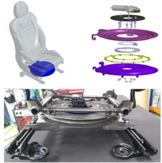
Şekil 6. Dönme mekanizması tasarımı (Swivel mechanism design)
