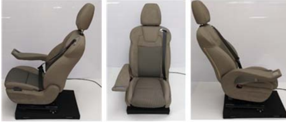
Şekil 13. Otonom sürüş için geliştirilen ön koltuk prototipi (The front seat prototype developed for autonomous driving)
