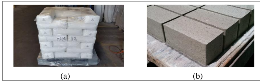
Şekil 4. Geri dönüştürülmüş hafif harç (a) ve hafif blok (b) (Hlawatsch vd., 2018)
