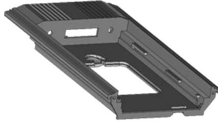
Şekil 2. Mobil kayıt cihazı ana kasa üst kızıağı.
