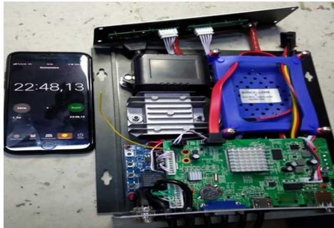
Şekil 6. Konvansiyonel mobil kayıt cihazının üretim durumu (üretim süresi: 23 dk).
