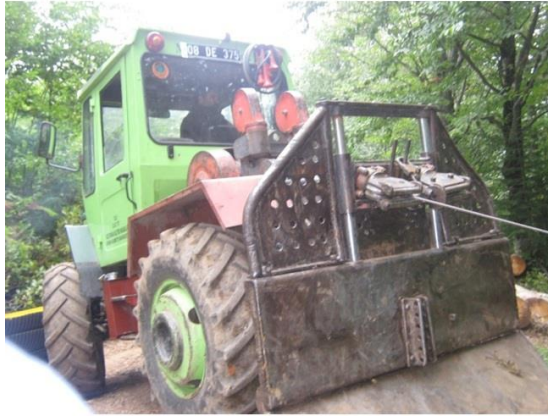
Şekil 11. Tomrukların oluk güzergahı içerisinde MB Trac 900 orman traktörü gücüyle aşağıdan yukarıya orman yoluna doğru çekilmesi
