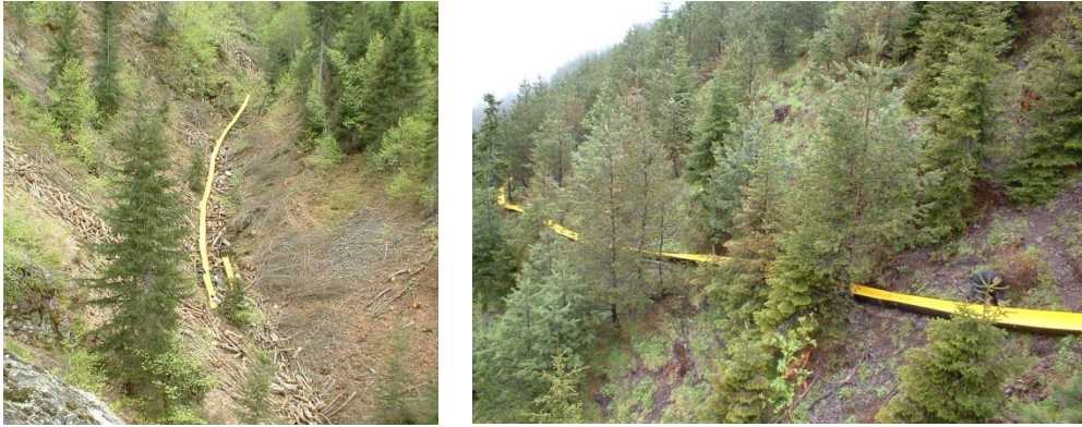
Şekil 9. Plastik oluklar ile bölmeden çıkarma örnekleri Figure 9. Examples of logging with a plastic chutes
