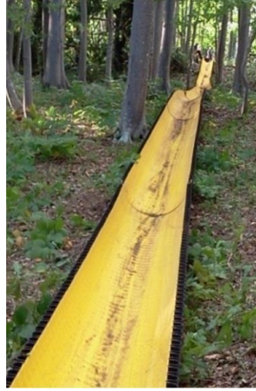
Şekil 10. Oluk güzergahı ve arazide kurulumu Figure 10. Installation of plastic chutes and land routes
