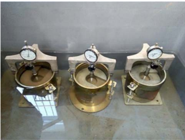
Şekil 4. Suda bekletilen CBR numuneleri (CBR samples soaked in water)
