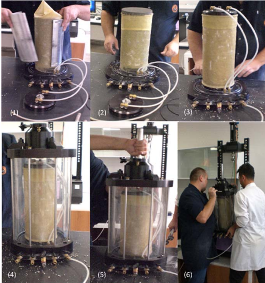
Şekil 5. Numunenin hücre içerisine yerleştirilmesi işlemleri (Placing the sample in the cell)
