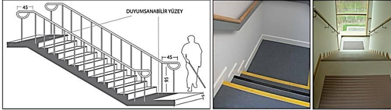
Şekil 14. Merdivende duyumsanabilir yüzey kullanımı (DEB, 2013, s. 26), (CEUD, 2020c, s. 16), (CEUD, 2020b, s. 30)
