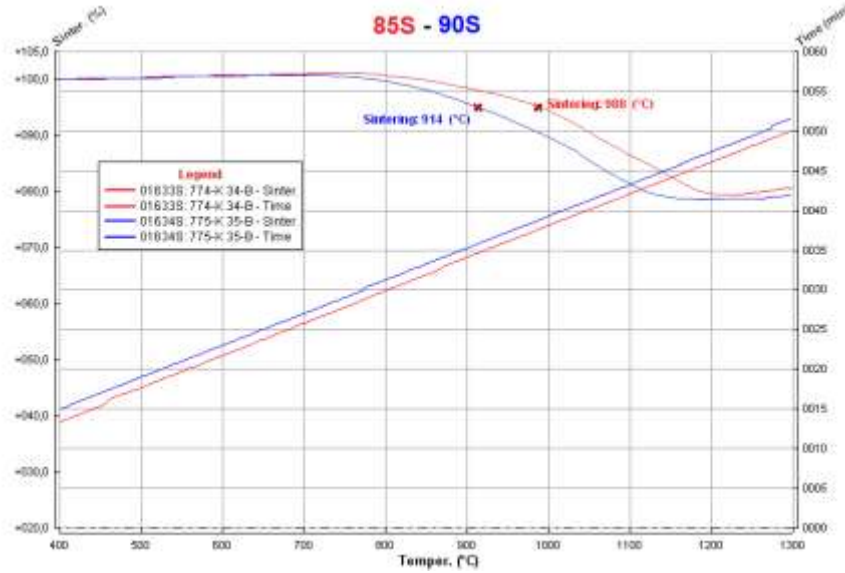
Şekil 4. Çini bünyelerinin 50 °C/dk hızla 1300 °C sıcaklığa kadar ısıtma sırasındaki davranışı.
