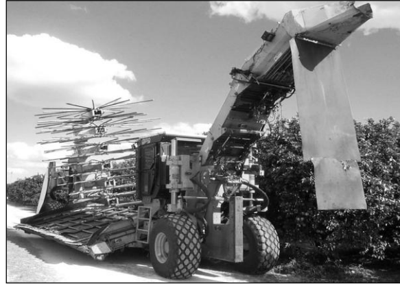
Şekil 5. Düşey düzlemde dönerek çalışan parmaklı batöre sahip silkeleyici
