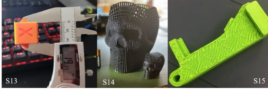
Şekil 7. Ekstruder ve tolerans sorunlarıyla ilgili parça örnekleri: S13: Ölçü tolerans hataları, S14: Küçük detayların üretim sorunları, S15: Destek yapılarla ilgili sorunlar.
