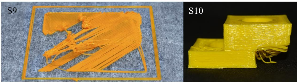
Şekil 5. Katman hataları: S9: İlk katman adezyon sorunu, S10: Katmanlarda kaymalar.
