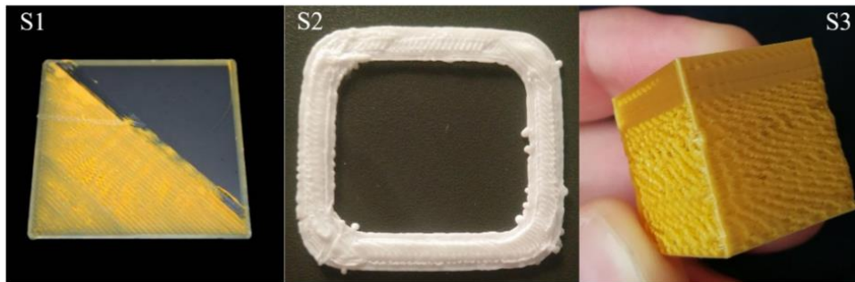
Şekil 2. Ekstrüzyon ile ilgili karşılaşılan sorunlar: S1: İlk katman ekstrüzyon sorunları, S2: Fazla ekstrüzyon, S3: Yetersiz ekstrüzyon.
