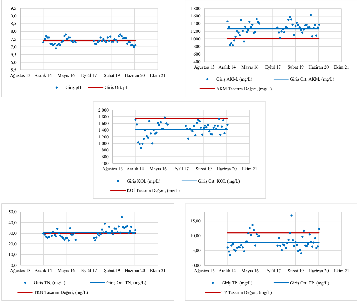
Şekil 6. Atıksu arıtma tesisi giriş atıksuyu özellikleri [12]
