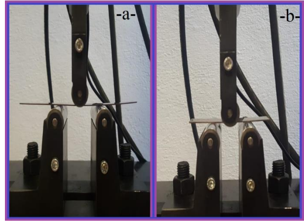
Şekil 1. Eğme testi için kullanılan test düzeneği a) 45°C dönüşüm sıcaklığına sahip sac b) 80°C dönüşüm sıcaklığına sahip sac (Test set up used for bending test a) sheet with 45°C transformation temperature b) sheet with 80°C transformation temperature)
