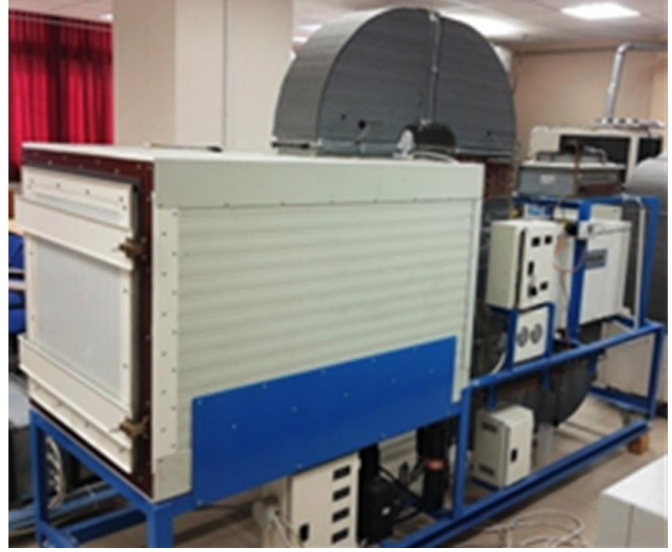
Şekil 5: Isı pompalı kurutucu sisteminin gerçek ve şematik gösterimi [4].
