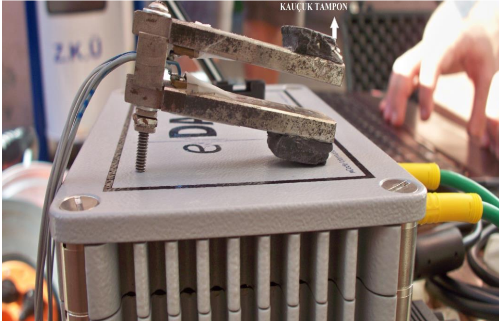
Şekil 2. Isırma çatalının, veri toplama sistemi üzerinde kullanım öncesi görünümü
