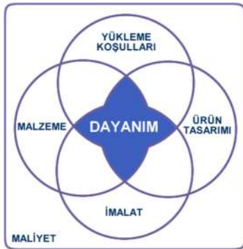
Şekil 1. Araç Dayanımını Etkileyen Parametreler (The parameters affecting vehicle durability)
