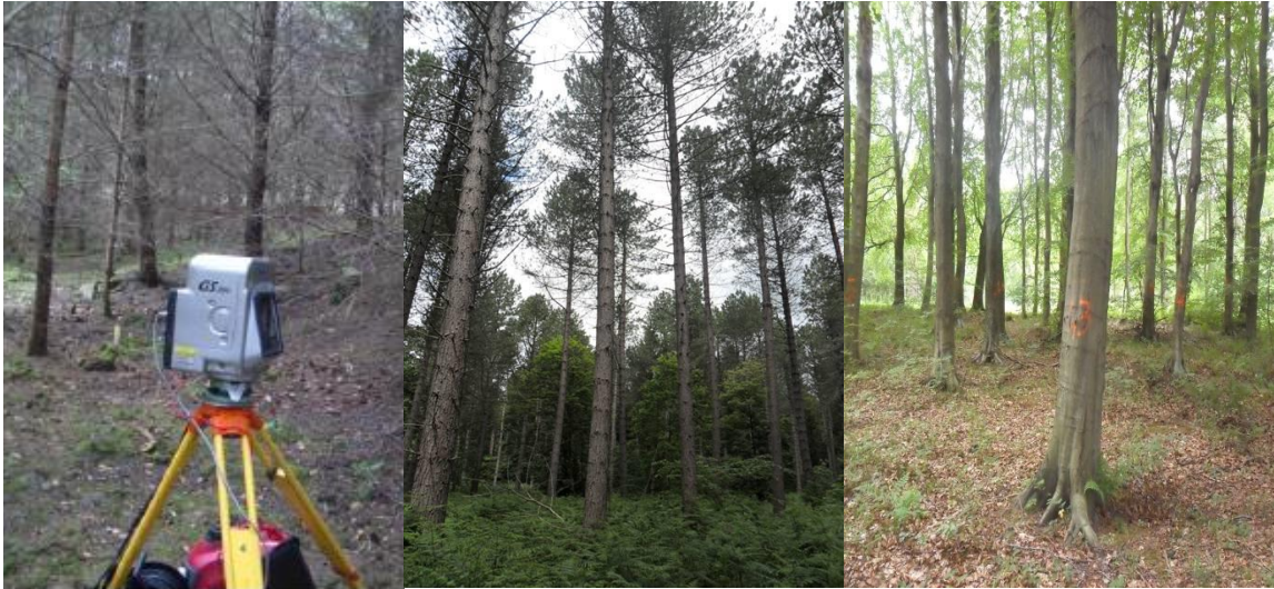
Şekil 2. Kullanılan YLT cihazı ve tarama yapılan meşcerelerden örnek görüntüler
