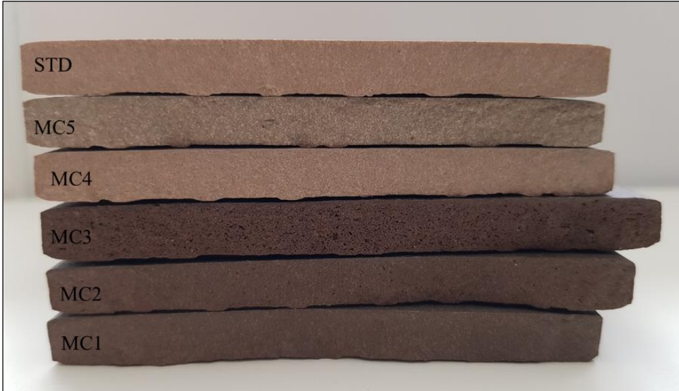
Şekil 7. Bünye reçetelerinin pişirim sonrası kesit görüntüleri
