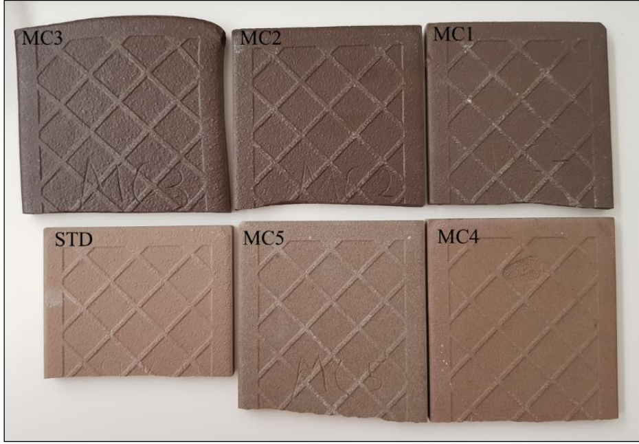
Şekil 6. Bünye reçetelerinin pişirim sonrası yüzey görüntüleri
