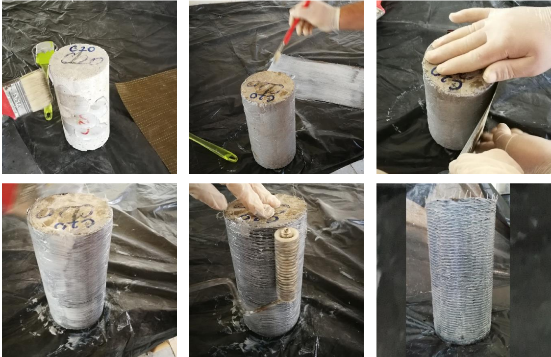
Şekil 2. Beton numunelerin BFRP ile yanal güçlendirilme aşamaları.
