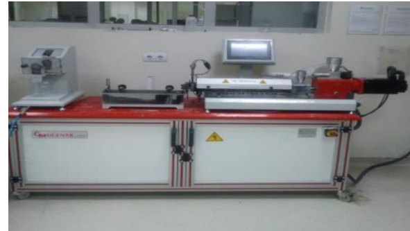
Şekil 1. Çift vidalı ekstrüder kullanarak kompozit numunelerin karıştırılması (Mixing of composite samples using a twin screw extruder)
