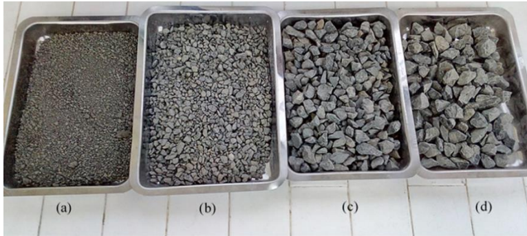
Şekil 1. (a) kırmataş tozu (0-5 mm), (b) mıcır 1 (5-12 mm), (c) mıcır 2 (12-19 mm), (d) mıcır 3 (19-37.5 mm)
