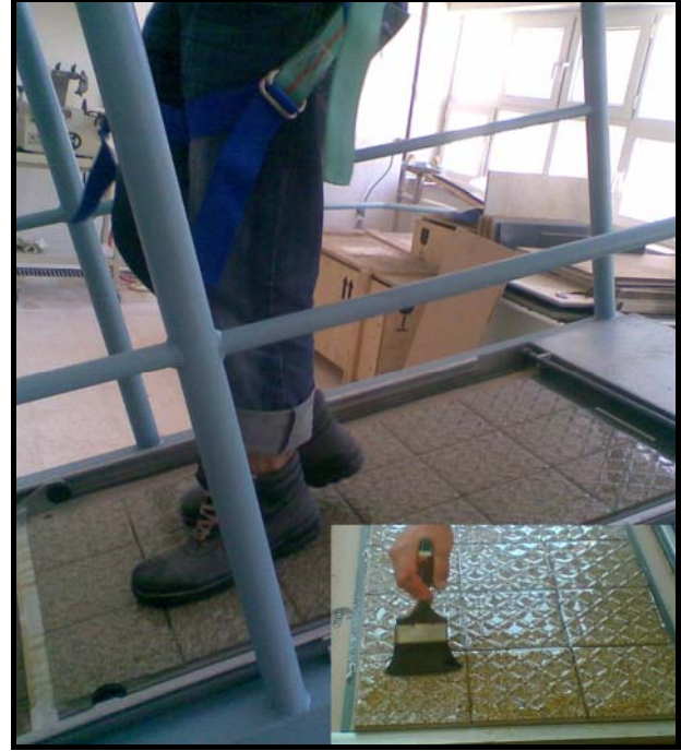
Şekil 2. Eğik düzlem kalibrasyon işlemi (SAM)
