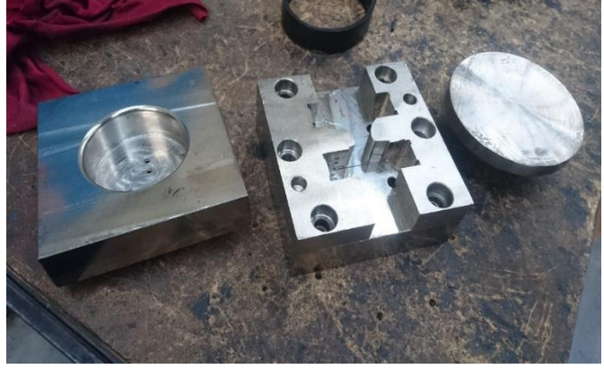
Şekil 6. Numune kompresyon kalıp tasarımı
