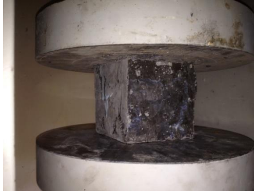
Şekil 2. Beton Basınç Deneyi Düzeneği
