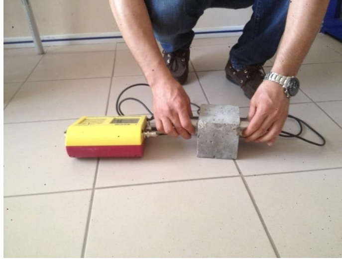
Şekil 9. Ultrasonik Ses Frekansı Deneyi Düzenegi
