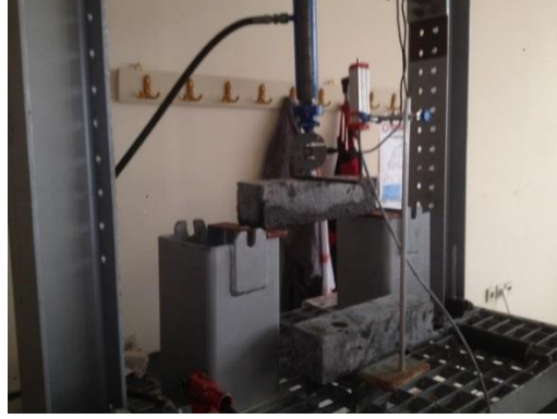
Şekil 3. Eğilme Dayanımı Deneyi Düzenegi
