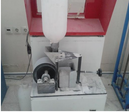
Şekil 7. Aşınma Dayanımı Deney Düzeneği
