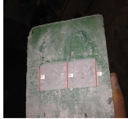
Şekil 8. Aşınma Dayanımı Deney Numunesi
