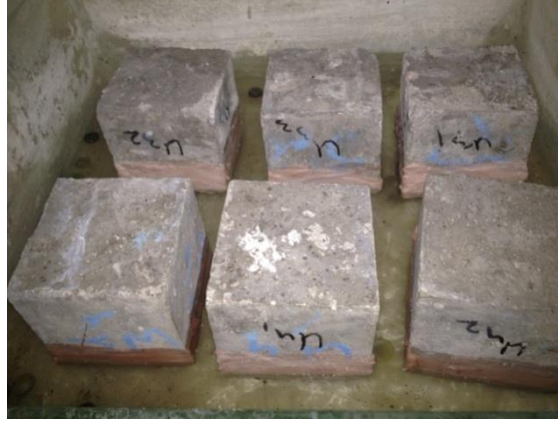
Şekil 4. Kapilarite Deneyi Düzenegi
