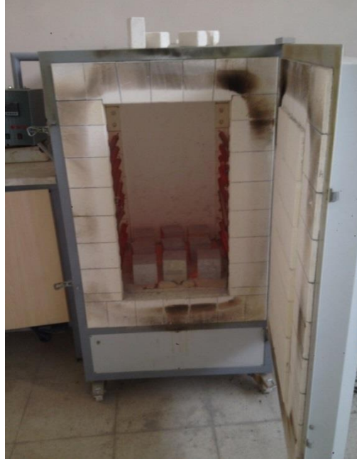
Şekil 6. Yangın Dayanımı Deneyi Düzenegi
