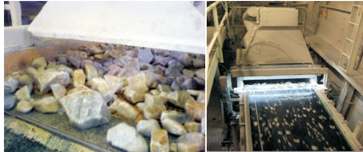
Şekil 7. Farklı boyutlarda kullanılan optik ayırma teknolojisine ait iki uygulama [16]
