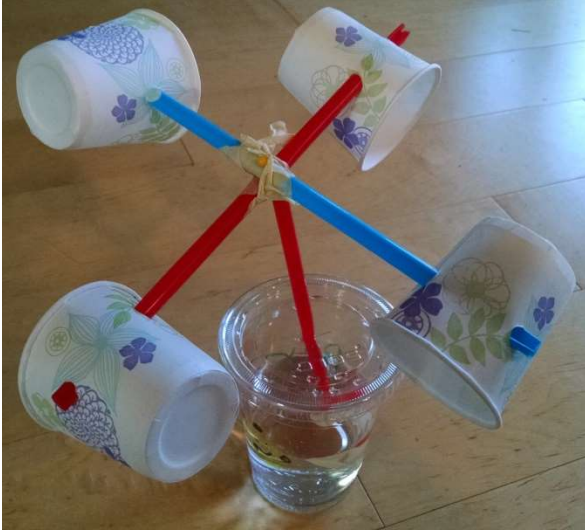
Görsel 8. Evdeki malzemelerle yapılmış basit bir rüzgâr ölçer
