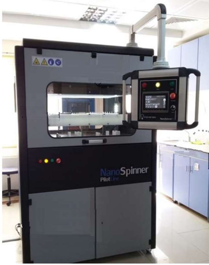
Şekil 3. Nanospinner inovenso pilotline çok iğneli yarı endüstriyel elektrospinning cihazı (Nanospinner inovenso pilotline multi-needle semi-industrial electrospinning device)
