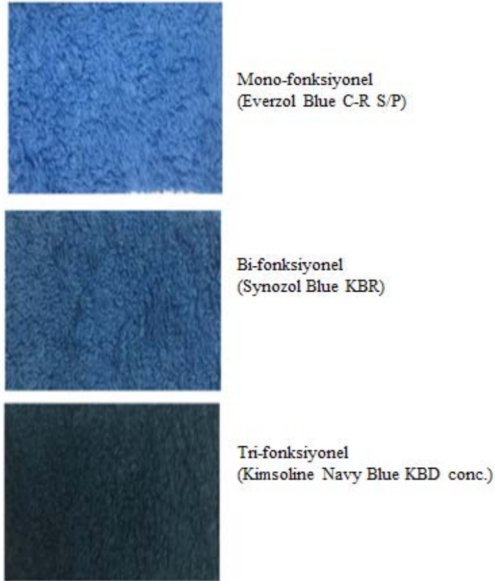
Şekil 4. Farklı reaktif grup sayısına sahip reaktif boyarmaddelerle boyanan kumaşlara ait görseller (Images of fabrics dyed with reactive dyes with different reactive group numbers)
