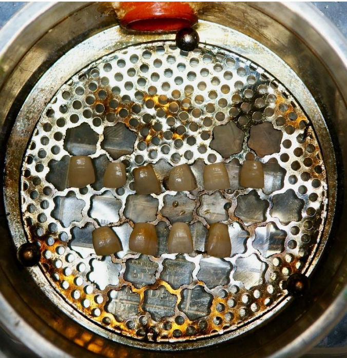
Şekil 3. Sigara dumanına maruz kaldıktan sonra numunelerin metal tabla üzerindeki görünümü.
