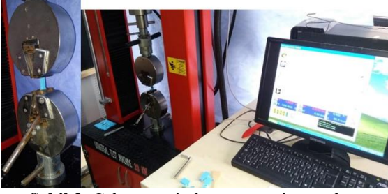
Şekil 3. Çekme testinde numunenin çenelere bağlanmış hali ve test uygulanması
